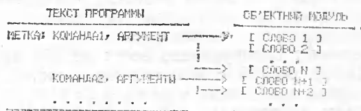
Рис. 3. Схема работы транслятора с языка ассемблер
